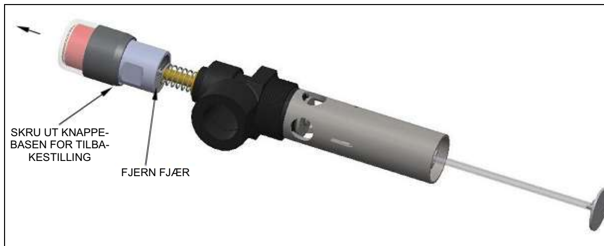
Figur 6B. TRINN 2 – Skru ut resettknappen og ta ut fjæren
